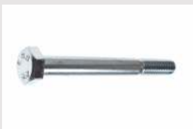
Śruba z łbem 6-kątnym z gwintem, drobnozwojnym na części DIN 960 ISO 8765 Kl. 4.8; 9.8; 10.9; 11.9 bez pokrycia, ocynk, A2, A4
