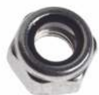
Nakrętka samo kontrolująca DIN 985, PN 82175, ISO 7040 Kl. 5.8; 8.8 bez pokrycia, ocynk, A2, A4
