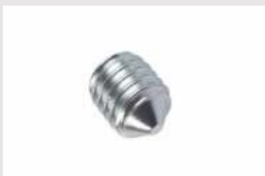
Wkręt dociskowy DIN 914, PN 82315, ISO 4027 bez pokrycia, ocynk, A2, A4
