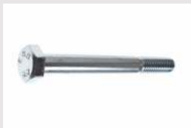
Śruba z łbem 6-kątnym z gwintem na części DIN 931, PN 85, ISO 4014, M 82101 Kl. 5.8; 8.8; 10.9; 12.9 bez pokrycia, ocynk, A2, A4, TZN, HV
