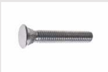
Śruba podsadzana ( płuźna ) DIN 605, PN 82402, ISO 8676, Kl. 5.8; 8.8 bez pokrycia, ocynk
